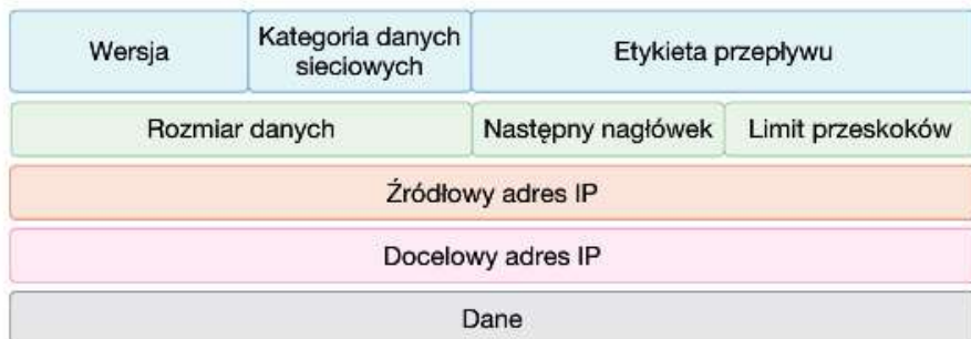
Rys. 6.6. Budowa pakietu IPv6
